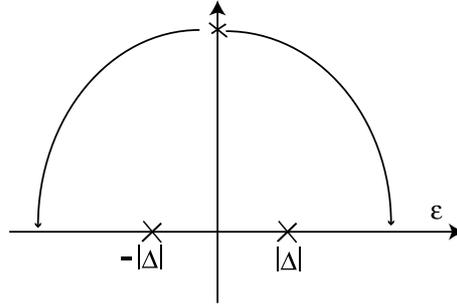
図 2: 温度 Green 関数を遅延 Green 関数へと変換する際の複素平面上での経路。ε の正負によって  $\text{Re } g^R$  の偏角が異なる。
